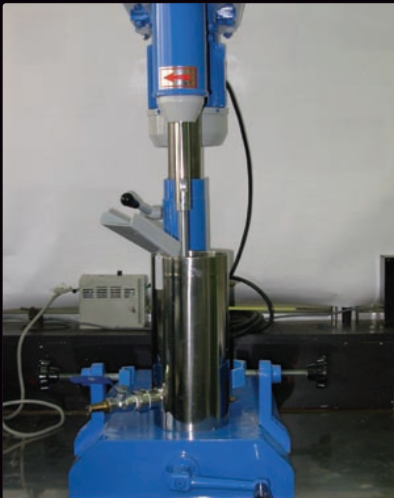
Dispersora de alta velocidad para la producción de las pinturas.
