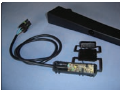
Sensor (1er prototipo sin procesamiento, vista del circuito eléctrico) y caño de bajada de semillas
