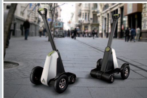
9611 Movete: vehículo eléctrico unipersonal Vehículo eléctrico unipersonal de accionamiento manual y dirección trasera. Se destaca por simplificar la tecnología de producción frente a otros productos de la misma tipología, logrando la estabilidad con cuatro ruedas y dimensiones que no superan al usuario, siendo posible su producción nacional.
