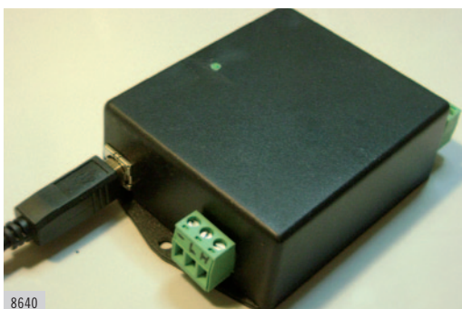
8640 Caja negra para automóviles: registro y detección de eventos en la conducción Guarda registros de posibles choques con vehículos que circulan por el mismo camino y también de posibles salidas del camino (por error del conductor, por cansancio, etc.).
