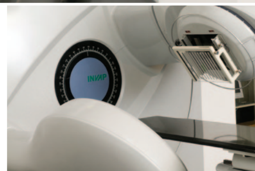
10650 Equipo de radioterapia TERADI 800 Equipo de teleterapia desarrollado, fabricado y comercializado por la firma INVAP. Se trata de un sistema de haces externos con Cobalto-60 isocéntrico diseñado para cargar fuentes de alta actividad, con una capacidad de carga de 200 RMM.
