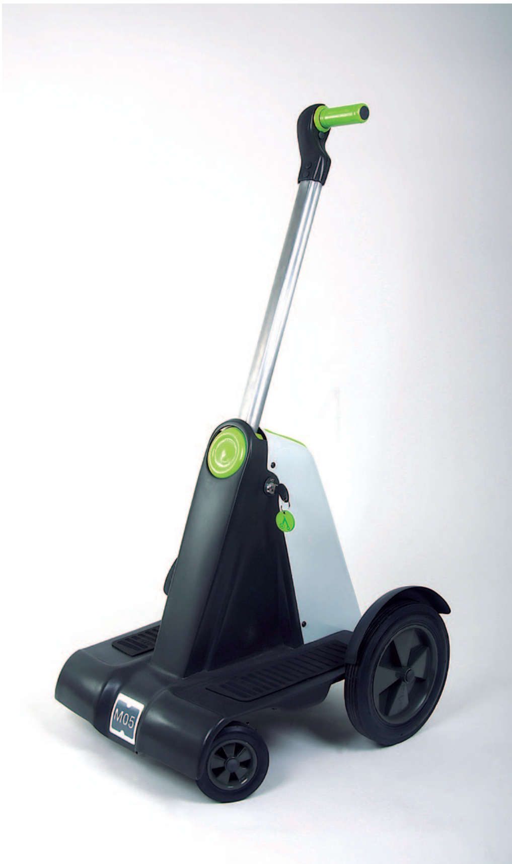
9611 Movete: vehículo eléctrico unipersonal Vehículo eléctrico unipersonal de accionamiento manual y dirección trasera. Se destaca por simplificar la tecnología de producción frente a otros productos de la misma tipología, logrando la estabilidad con cuatro ruedas y dimensiones que no superan al usuario, siendo posible su producción nacional.
