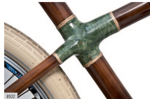
8932 Bambucicleta: bicicletas de bambú Bicicletas de diseño de media y alta gama, fabricadas íntegramente en bambú (cuadro y horquilla) y diseñadas específicamente para el uso urbano, cotidiano y recreativo.
