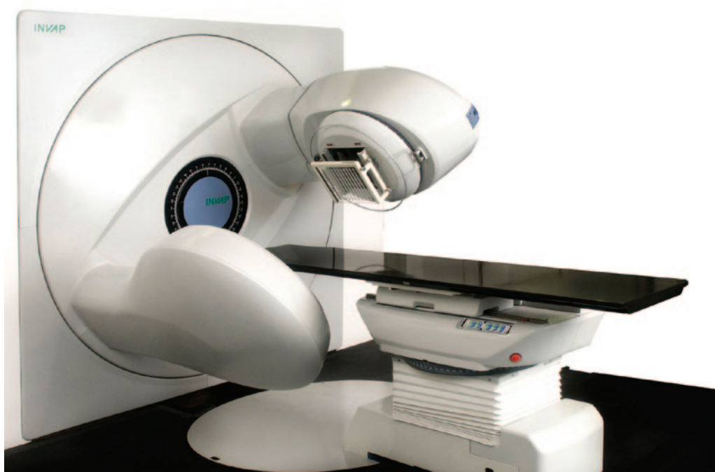
10650 Equipo de radioterapia TERADI 800 Equipo de teleterapia desarrollado, fabricado y comercializado por la firma INVAP. Se trata de un sistema de haces externos con Cobalto-60 isocéntrico diseñado para cargar fuentes de alta actividad, con una capacidad de carga de 200 RMM.
