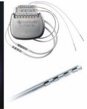
Dispositivo open-loop DBS y electrodo de estimulación (Medtronic)
