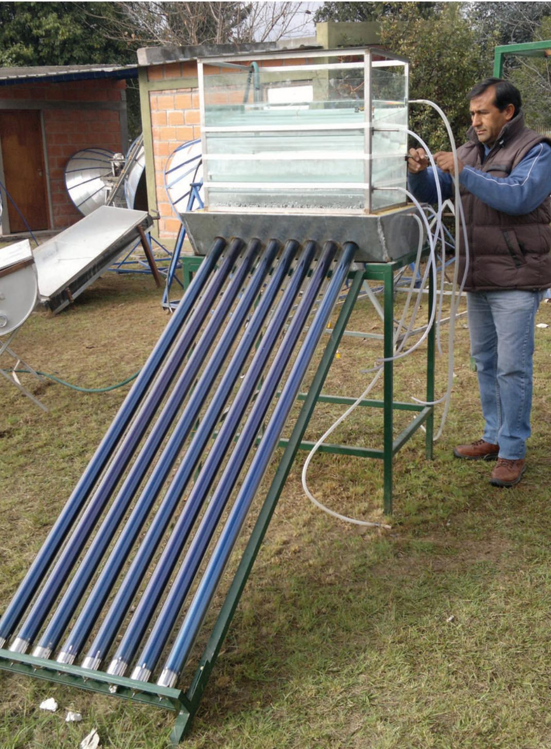
**El sistema desarrollado utiliza únicamente la radiación para eliminar la contaminación salina y orgánica del agua. Es ideal para poblaciones aisladas ya que puede producir entre 30 y 100 litros diarios de agua potable por medio de un mecanismo simple y de bajo costo.**
