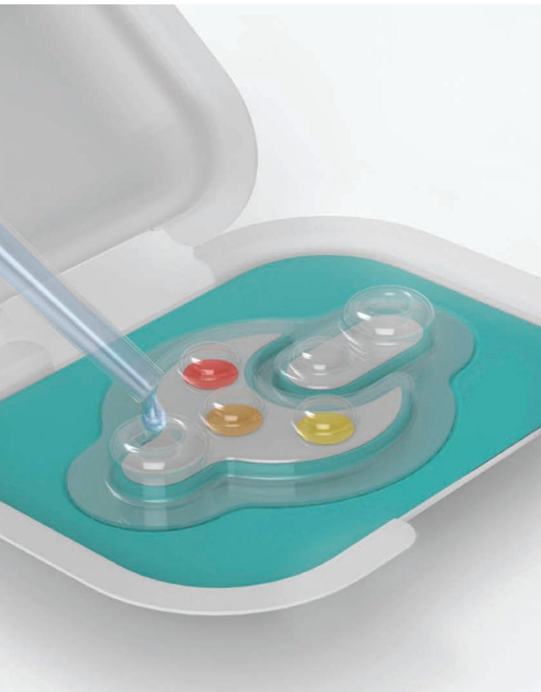
**El arsénico es una problemática a nivel mundial que contamina de manera sigilosa las fuentes de agua potable que utilizan millones de personas en todo el mundo. SensAr es una herramienta que permite verificar, sin la intermediación de técnicos o expertos, si el agua utilizada diariamente contiene niveles de arsénico nocivos para la salud.**
