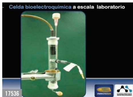
**17536** Electrodo para la generación de bioenergía
