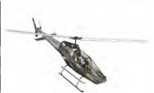
12792 Cicaré CH-14 - Helicóptero biplaza en tandem Disposición tandem: un asiento detrás del otro. Área frontal menor, reduciendo la resistencia al avance, economizando combustible y logrando mayor velocidad con menos potencia. 📍 Saladillo, Buenos Aires 🌐 http://galeria.innovar.gob.ar/12792
