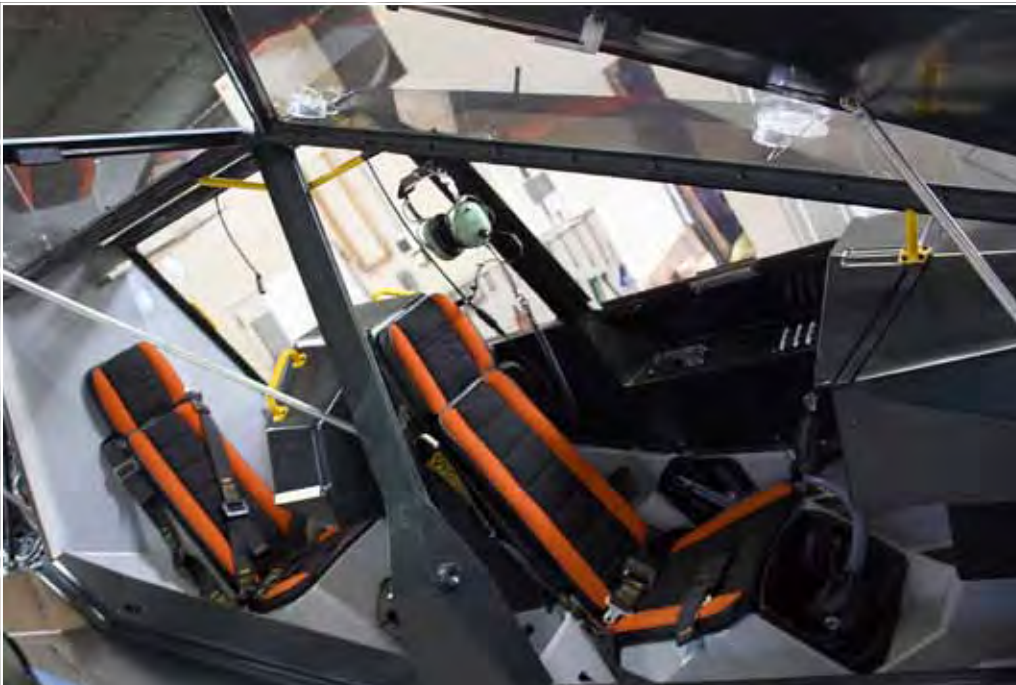
12792 Cicaré CH-14 - Helicóptero biplaza en tandem Disposición tandem: un asiento detrás del otro. Área frontal menor, reduciendo la resistencia al avance, economizando combustible y logrando mayor velocidad con menos potencia. 📍 Saladillo, Buenos Aires 🌐 http://galeria.innovar.gob.ar/12792
