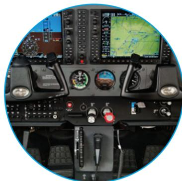
**2018-1334****EFIS - Electronic Flight Instrument System**
