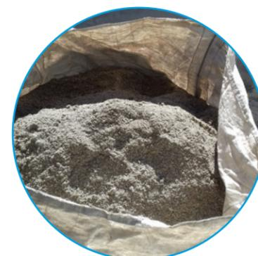
**2018-0279****Convertidor de microplásticos a áridos cementicios**
