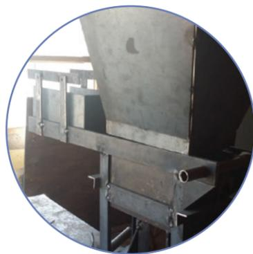
**2018-1057****Máquina-prensa ladrillos suelo-cemento**
