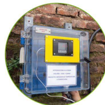
**2018-1679****Medidor de temperatura a termocupla**
