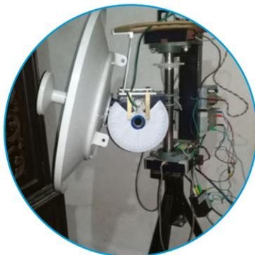
**2019-1650****Sistema de posicionamiento angular de antena parabólica**
