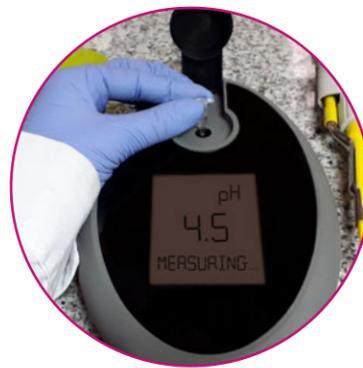
**2019-1079****Sensor descartable de pH para microvolúmenes**
